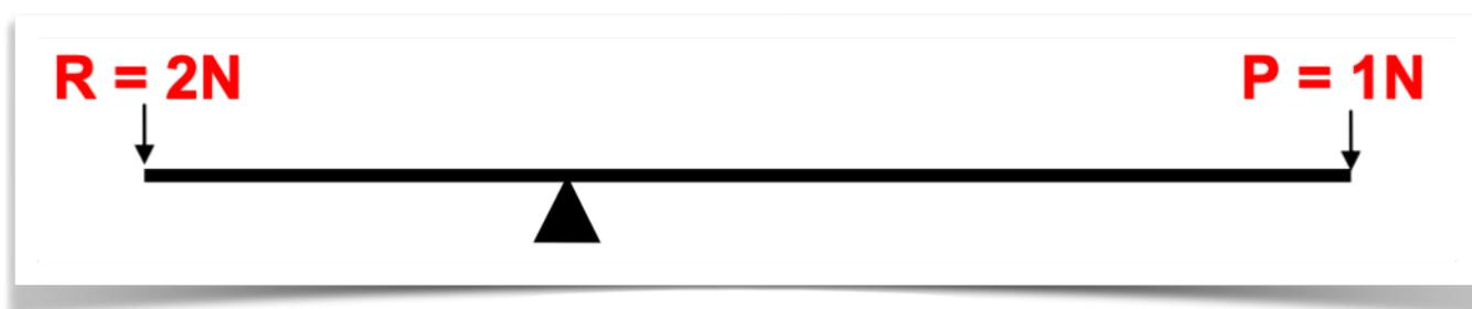
Nel nostro esempio, una resistenza di **2 Newton**, è tenuta in equilibrio da una potenza di **1 Newton**.
